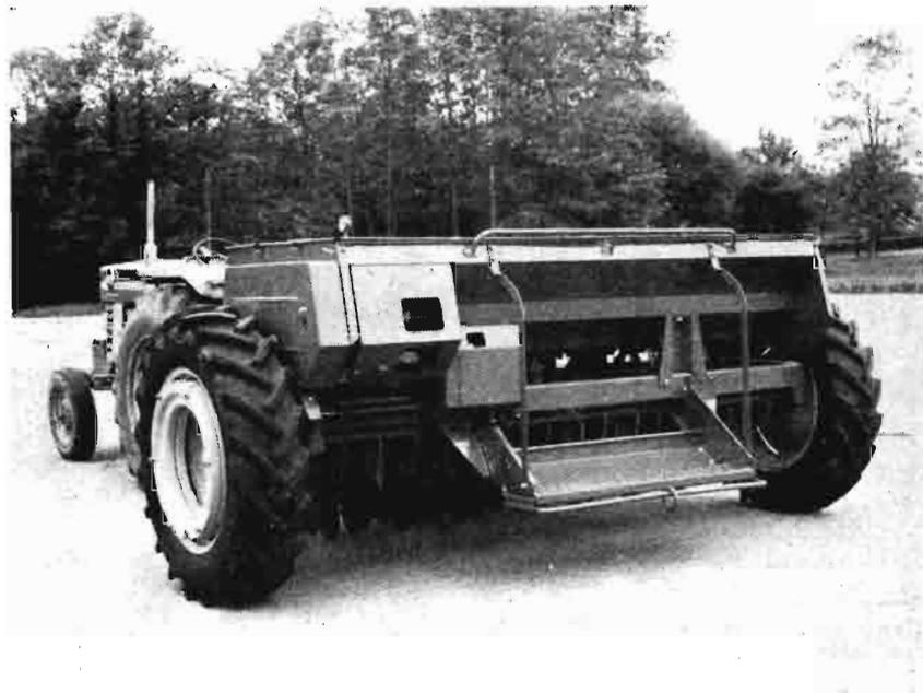
mayor tamaño, ensanchan dicha ranura a los efectos de la introducción de semillas y fertilizantes. Normalmente, el disco delantero se coloca a una altura inferior en 1,27 centímetros a los discos posteriores, pero este método se puede invertir para limitar la penetración en terrenos blandos y sementeras cultivadas mediante la elevación del enganche de la barra de arrastre o modificando la posición de los discos delanteros. Las quince rejas ajustables, que
