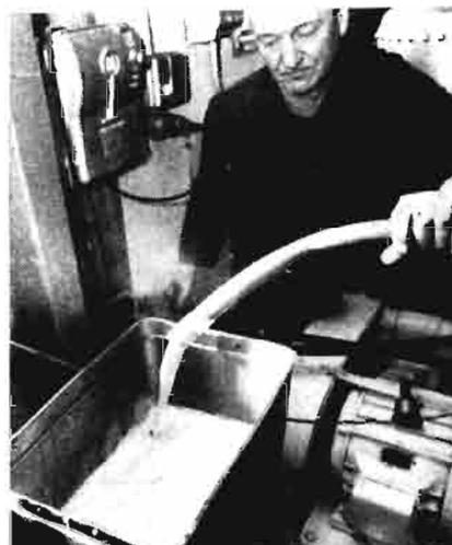
La leche vegetal pasa de un homogeneizador giratorio a un tanque, antes de ir a la cámara de vacío, donde se eliminará el aire previamente al envase
