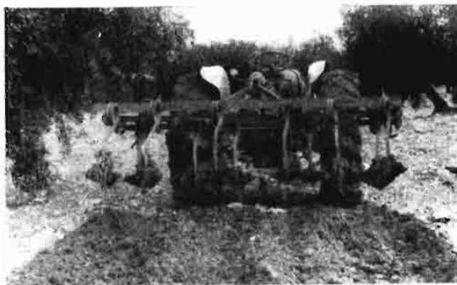
Arado escarificador, que permite mantener el terreno libre de vegetación espontánea, evitando al máximo las pérdidas de humedad y cuya labor es más eficaz para la defensa del suelo erosionable que el arado de gradas de disco
