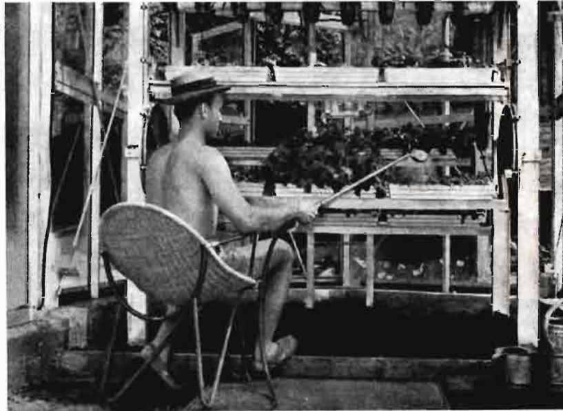
Puesto de trabajo en una torre de cultivo industrial continuo, tipo 7/4/G, de 10 metros de altura, en la Escuela de Horticultura de Langenlois (Baja Austria). Debido al movimiento de las cadenas sinfin, las plantas en cultivo van pasando por delante del operario. De esta forma pueden llevarse a cabo diferentes manipulaciones sin moverse del lugar de trabajo.
