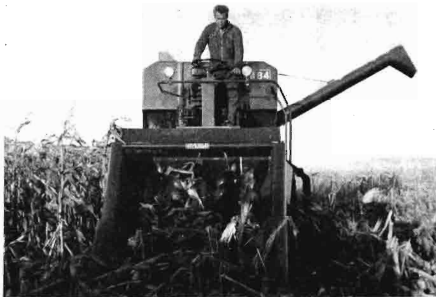
Las cosechadoras normales de cereales pueden adaptarse a la recolección del maíz. Véase el primer plano del mecanismo arrancador de mazorcas.
