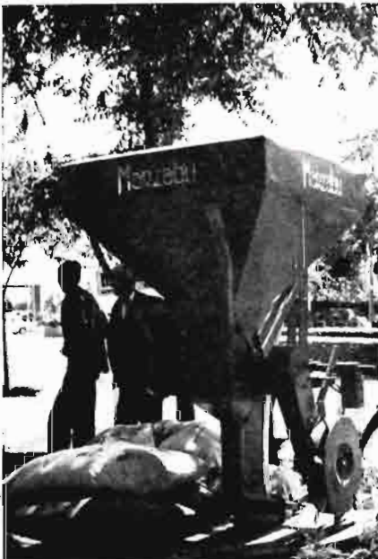
Abonadora localizadora de abono en profundidad, presentada en la Feria del Campo de Manzanares. Estas máquinas permiten colocar los abonos directamente al alcance de las raíces de las vides y otros cultivos frutales. A la derecha se aprecia la rueda que acciona el mecanismo distribuidor de la máquina.
