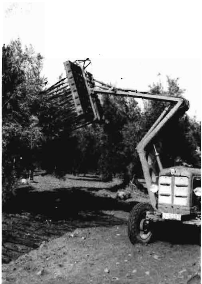
Una idea original: un conjunto de varas vibrátiles y montadas en el extremo de un brazo articulado. Todo ello montado y accionado por el tractor.
