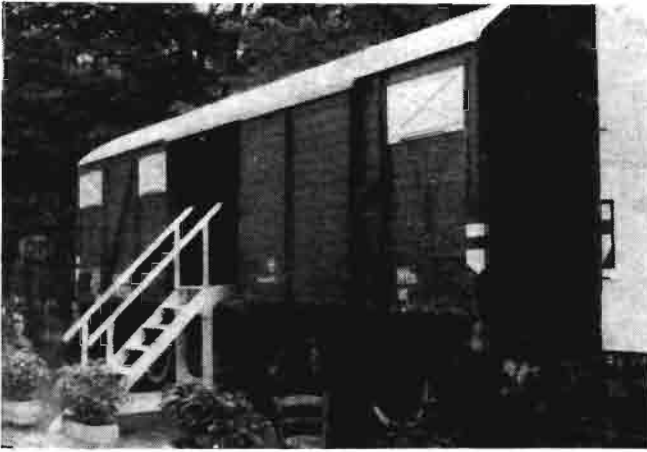
Vagón ventilado, que se utiliza en el transporte de frutas y hortalizas de carácter no muy poco perecedero. La aireación se realiza por medio de las ventanas enrejilladas que posee (ocho en total) y que tienen tres posiciones. Cerrada, como en la fotografía, cuando la temperatura exterior puede ocasionar riesgos de helada. Posición intermedia y totalmente abierta, según las condiciones exteriores. Unas normas racionales en la carga de las mercancías permiten la perfecta aireación del contenido, que se produce por la velocidad del vehículo.
