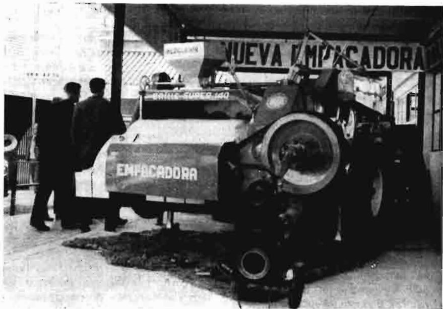
Recogedora-picadora-empacadora que constituyó una de las novedades de la Feria.
