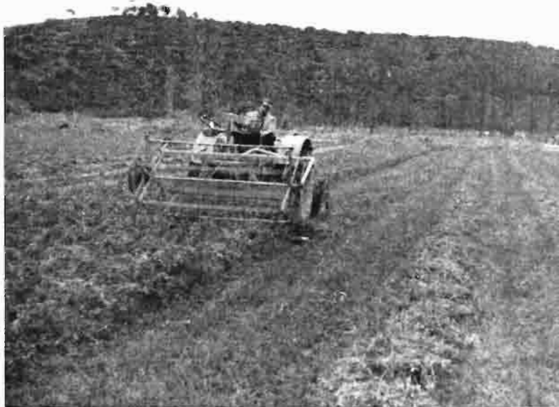
Segadora hileradora de posición trasera para trabajar marcha atrás el tractor. Una recogedora cargadora completará el trabajo de recolección.
