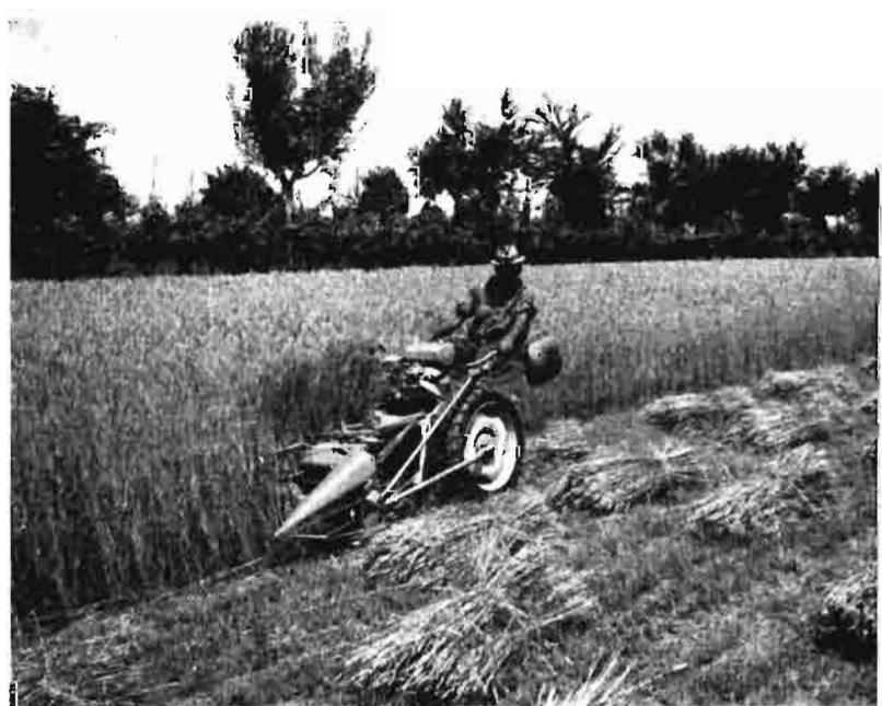
Segadora automotriz trabajando en cultivo de cereales. Máquinas de este tipo pueden prestar una gran ayuda en la recogida de las leguminosas para grano.
