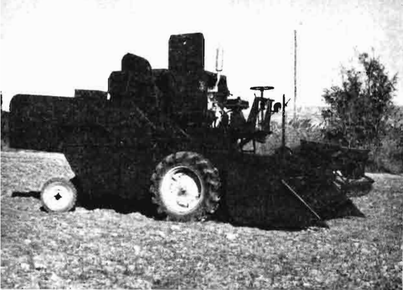
Las cosechadoras de cereales pueden adaptarse para la recolección de las leguminosas de grano. Para ello se disminuye el número de revoluciones del desgranador, se le suprimen varillas al cóncavo y se cambian las cribas por otras más adecuadas. A menudo se sustituye también la barra de corte por un recogedor tipo pick-up para trabajar sobre cosecha ya hilerada.
