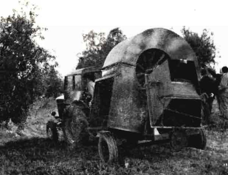
Ventilador capaz de crear un verdadero huracán, dispuesto a entrar en funcionamiento.
