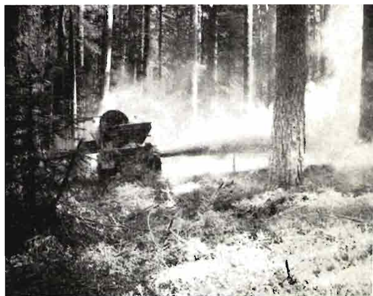
Demostración de encañado en un bosque con turbina espolvoreadora acoplada a tractor en Freudeustadt (Selva Negra).
