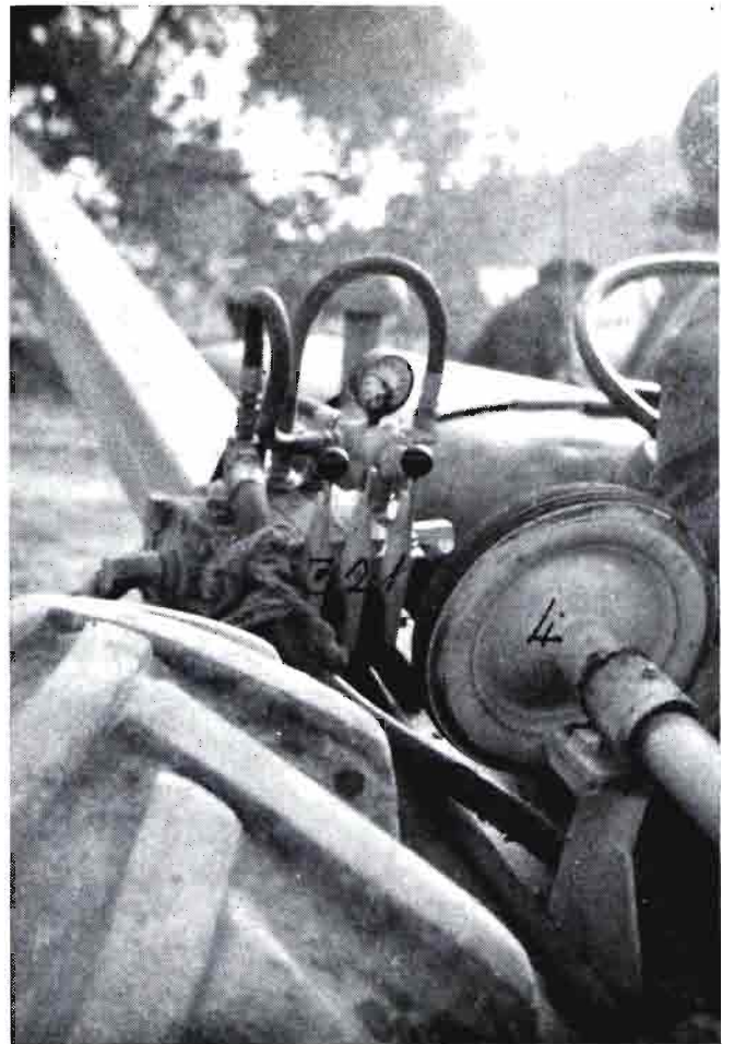
Mandos: 1, hidráulico de elevación; 2, de apertura de garra; 3, de vibración; 4, volante del giro del brazo.
