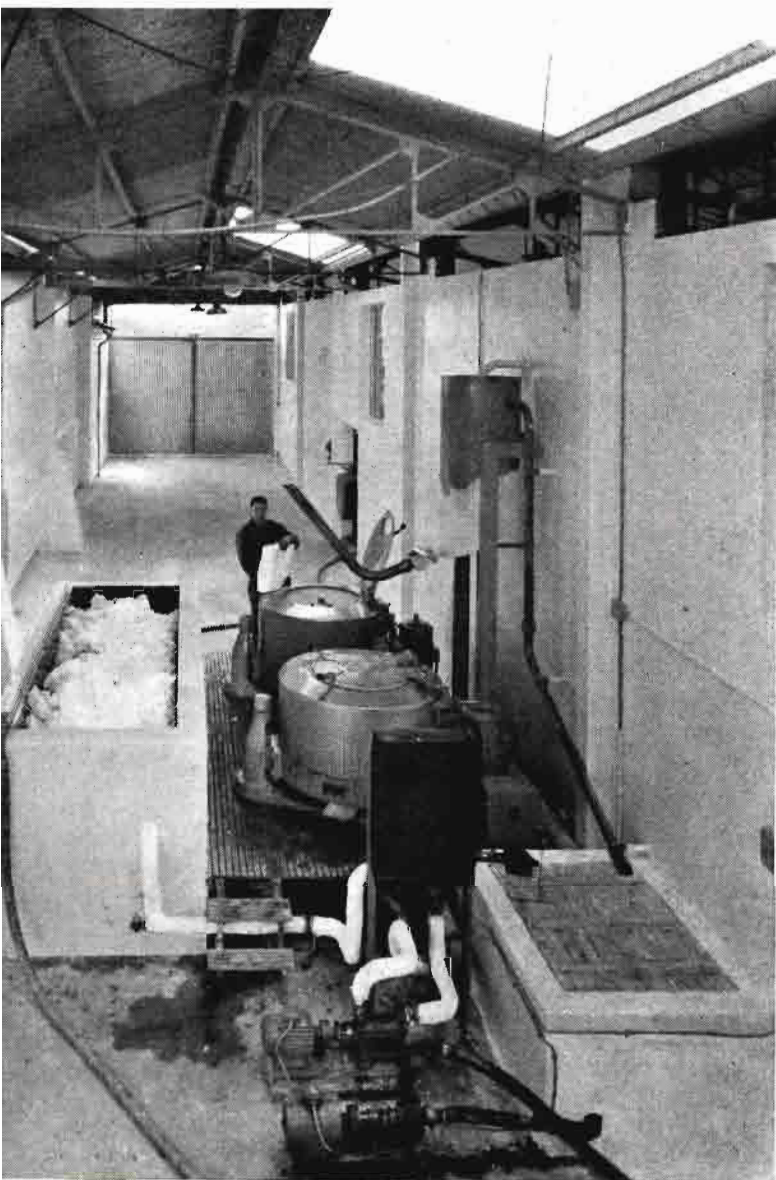
Aquí se aprecia con mayor detalle el concentrador en frío, marca Pepin Gasquet y Cia.
