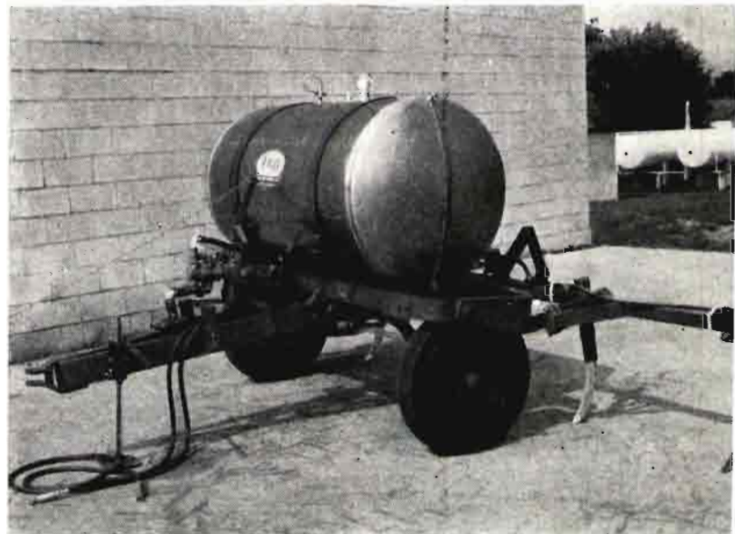
Fig. 6 Aplicador de soluciones nitrogenadas. En la parte delantera puede verse la bomba dosificadora.
