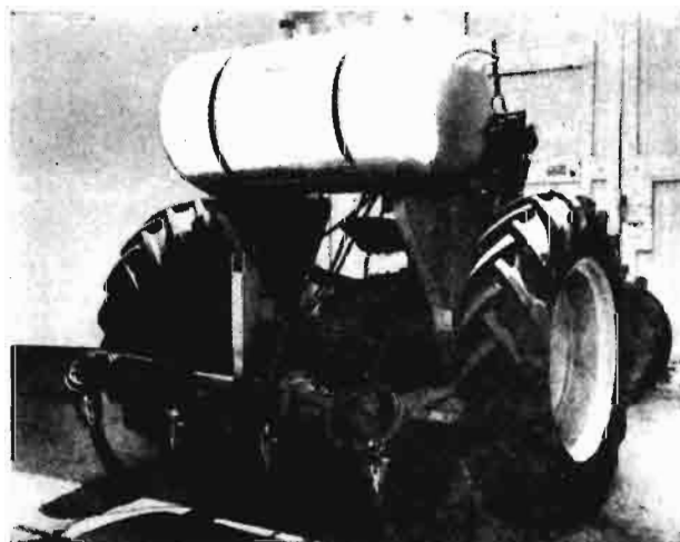
Foto núm. 4.—Dispositivo adaptado al tractor para la utilización del amoníaco anhidro.
