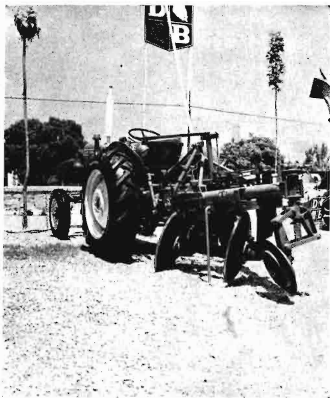
El arado se allgera y simplifica, como este giratorio bidisco, con bastidor tubular.
