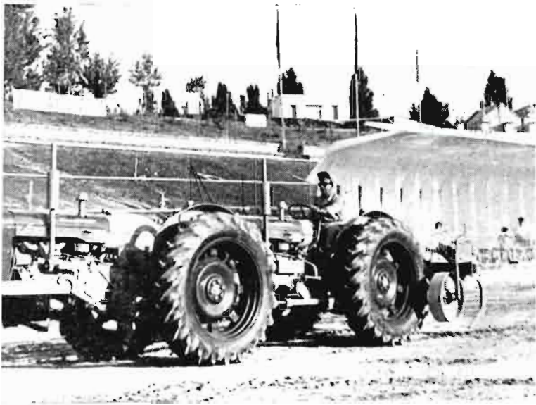
Quando hay que acumular potencia puede acudirse al acoplamiento de dos tractores iguales utilizando la manobra hidr ulica para conducirlos.
