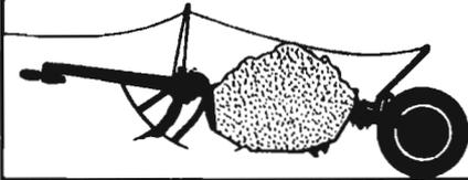
*La cuchara con la carga queda suspendida con amplio despejo sobre el suelo permitiendo emplear las más altas velocidades del tractor en el transporte.*
