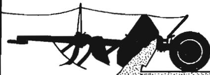
*Por un sencillo mecanismo se efectúa la descarga y puede realizarse su esparcimiento, bien mediante un control exacto en su espesor o totalmente.*
