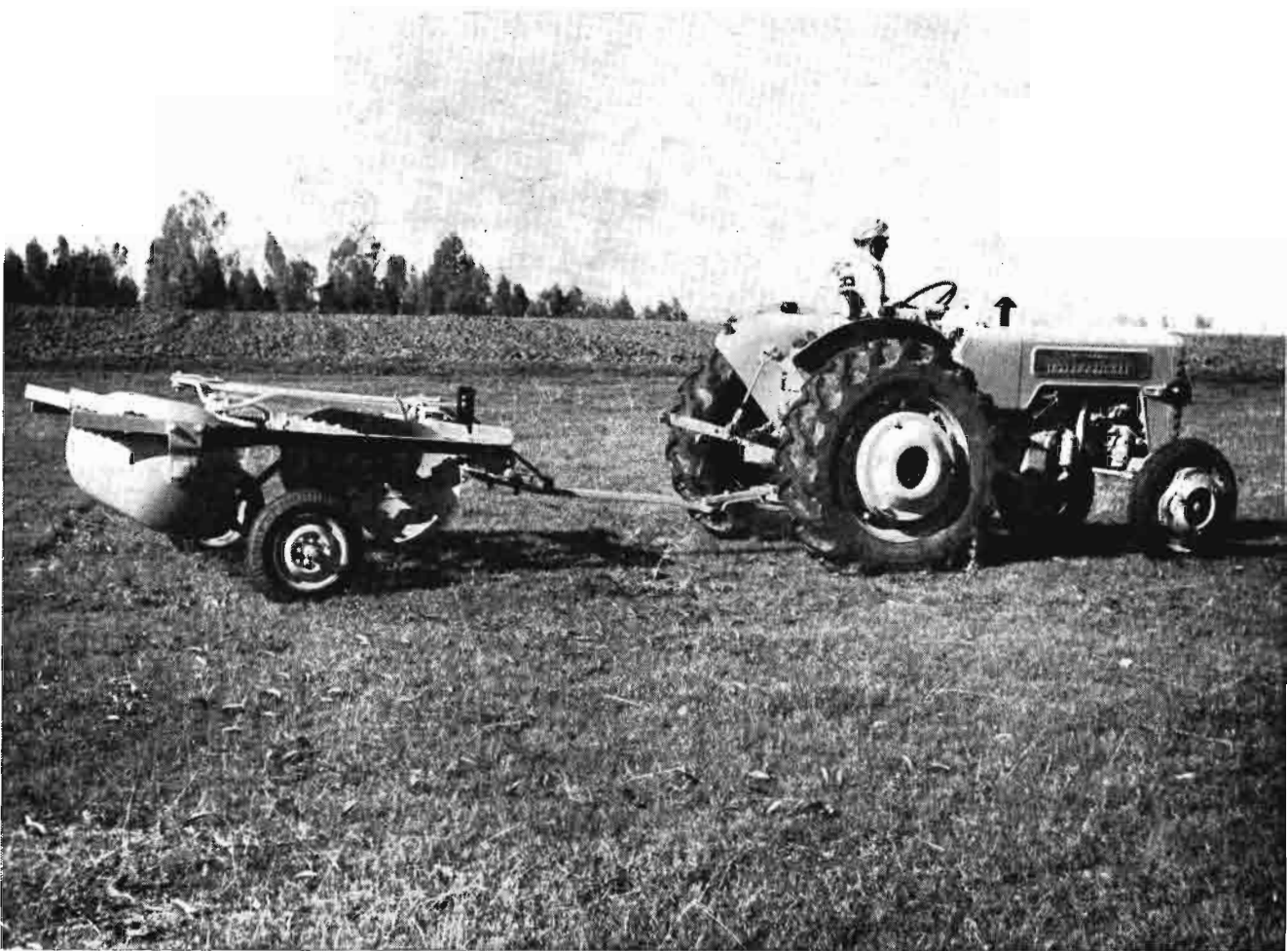
El apero debe estar provisto de ruedas para el transporte o poderse elevar mediante el alzamiento del tractor, pues la movilidad es una condición indispensable de las máquinas agrícolas.
