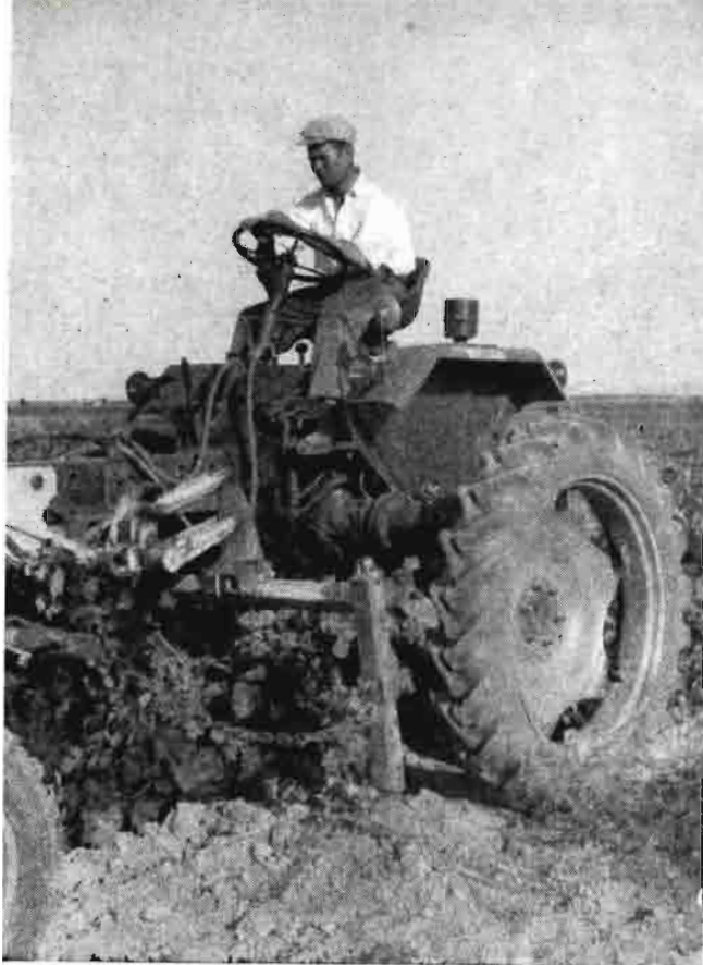
La situación del apero, muy cerca del centro de rotación del tractor, hace que la variación de posición de la herramienta con los cambios de dirección sea mínima.
