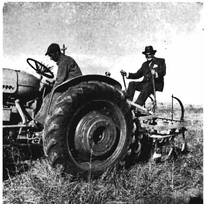
Multibridador «D» con palancas para su desplazamiento transversal, lo que permite seguir con precisión las sinuosidades de la siembra. Bloqueando las palancas, funciona con un tractorista solo, como el multiplicador de ballestas corriente (C).
