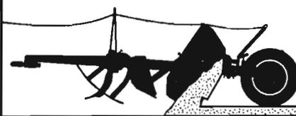
*Por un scocillo mecánico se efectúa la descarga y puede realizarse su esparcimiento, bien mediante un control exacto en su espesor o totalmente.*
