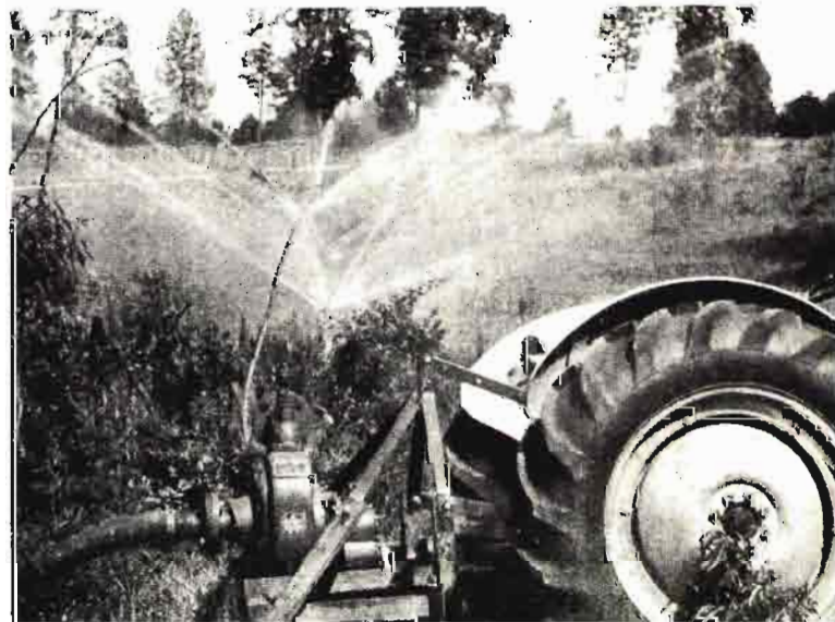
Bomba centrífuga, que se ceba a sí misma, conectada a la toma de fuerza de un tractor.
