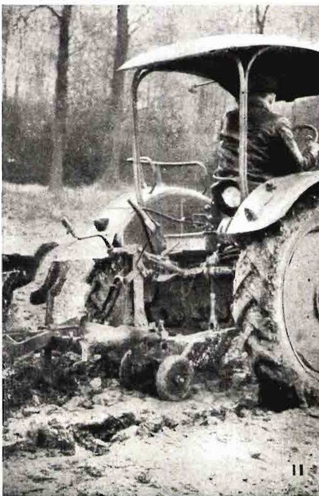
Foto 11.—Control automático de profundidad.
