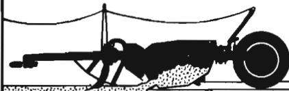
*Brazas con dientes excavadores facilitan la penetración de la cuchilla. Esta disposición permite efectuar cargas colmadas con menos resistencia.*
