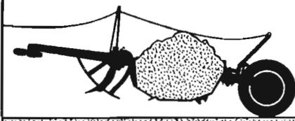
*La cuchara con la carga queda suspendida con amplio despejo sobre el suelo permitiendo emplear las más altas velocidades del tractor en el transporte.*
