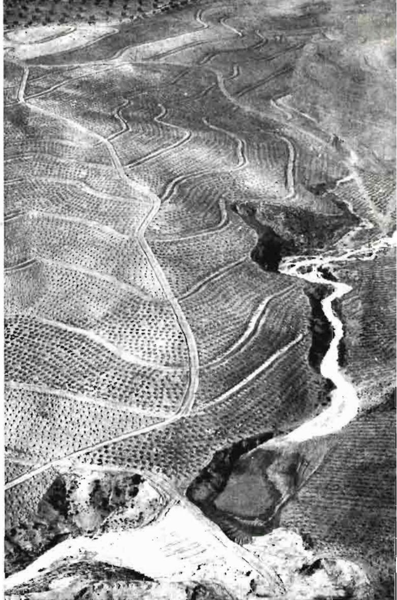
Plantación de viñedo entre terrazas en la finca Pinedo (Toledo). En la parte inferior derecha de la foto puede observarse una balsa con dique de tierra, sobre el cual pasa un camino y que ya ha recogido agua procedente del barranco.
