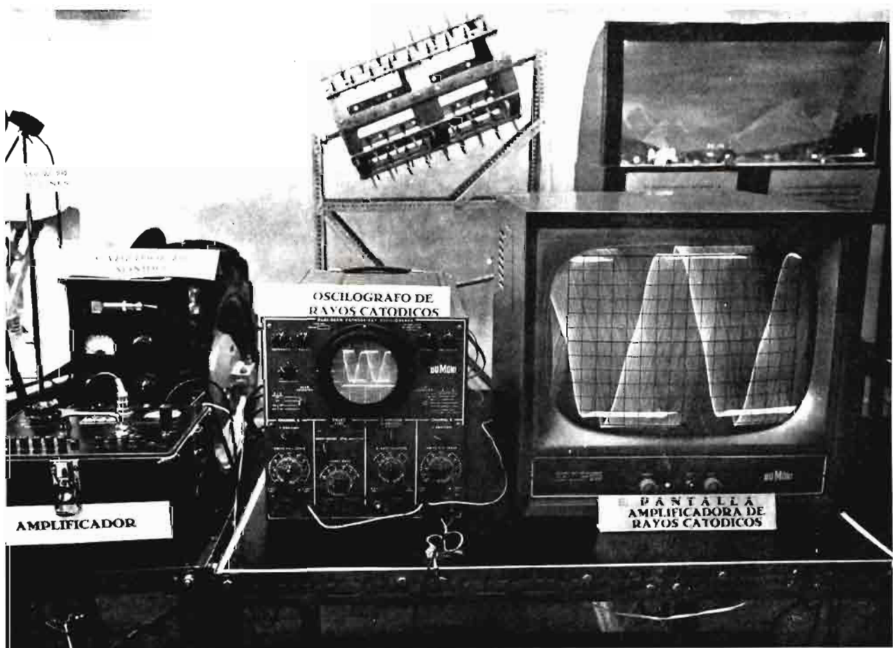
El Ministerio de Agricultura, en las instalaciones del Instituto Nacional de Investigaciones Agronómicas, ha destacado bajo el lema «Precisión y robustez inseparables en las máquinas agrícolas», la importancia de medir y corregir las vibraciones y los ruidos. El captador de vibraciones, acoplado al asiento de un tractor, permite registrar en las pantallas del oscilógrafo y el amplificador de rayos catódicos, los valores que alcanzan dichas perturbaciones.
