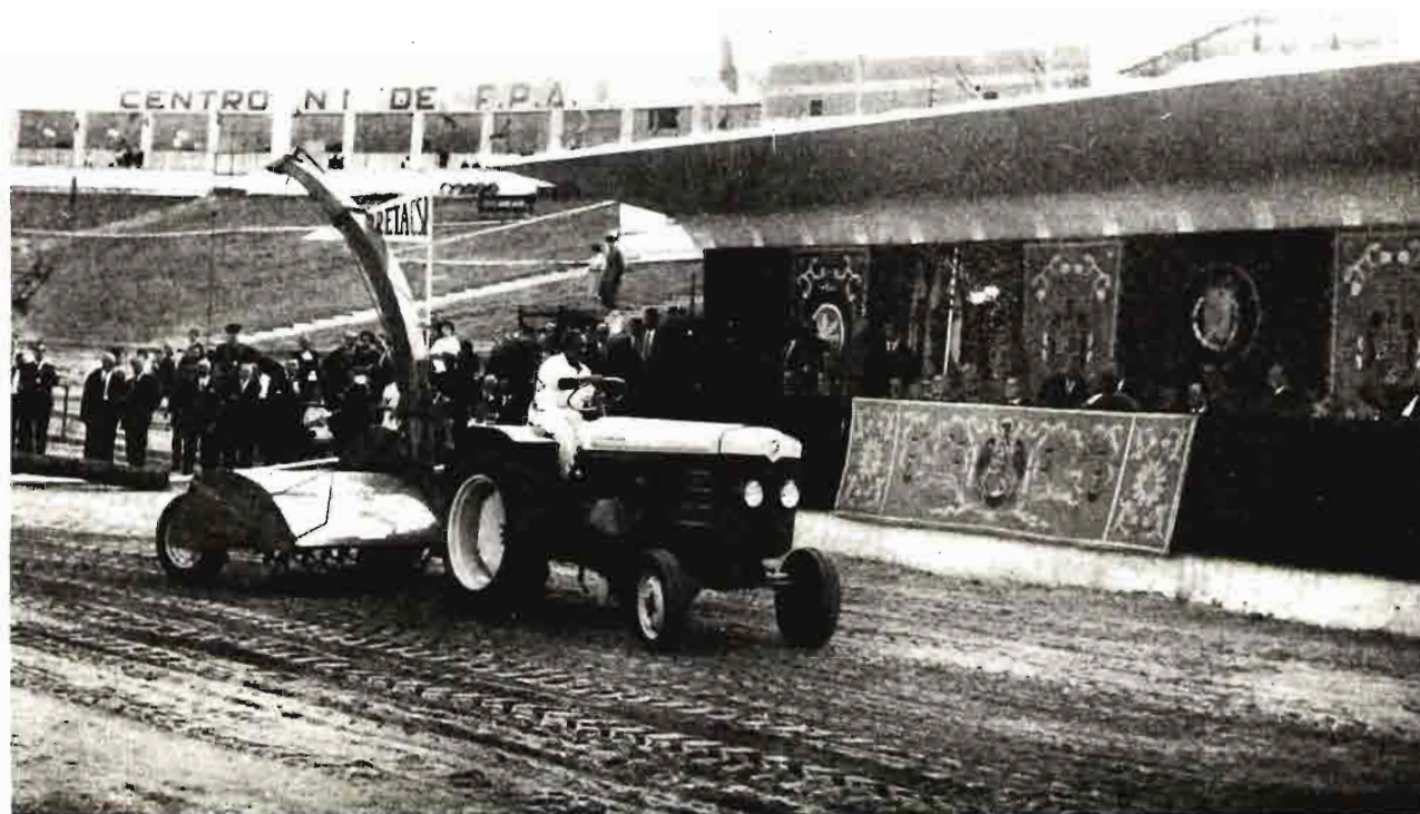
La versión más moderna de las cosechadoras de forraje nos la ofrece la máquina, que con un solo rotor siega, pica y carga el remolque acoplado a ella.
