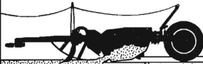
Brazos con dientes excavadores facilitan la penetración de la cuchilla. Esta disposición permite efectuar cargas colmadas con menos resistencia.
