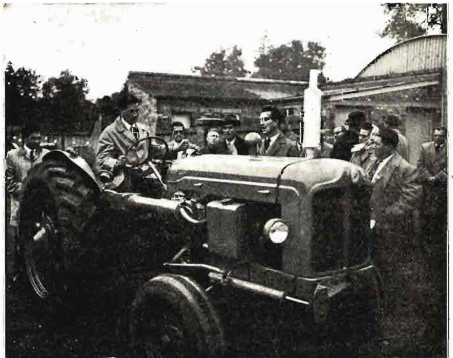
En Silzoe se realizan pruebas de accionamiento por turbinas hidráulicas, suprimiendo los engranajes.
