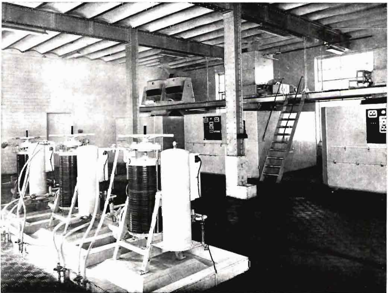
Extractores «Alfin», prensas de «Sagrera» y batería de filtros automáticos en serie.
