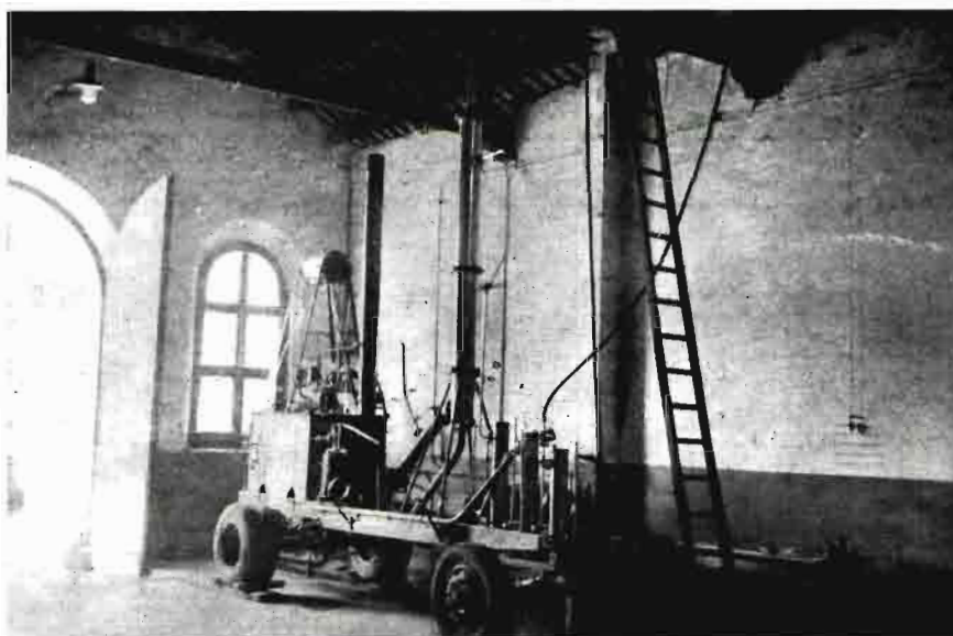
Aparato desulfitador Vento, que, operando en caliente, permite la obtención de mosto consumible en plena fermentación.
