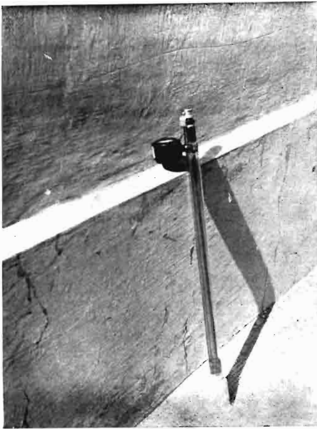
Tensiómetro «Irrigómetro», que sirve para medir la humedad del suelo.
