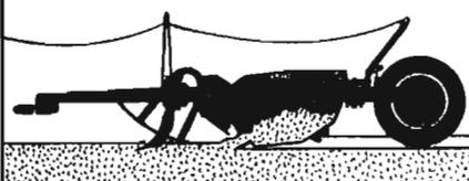
Brazas con dientes excavadores facilitan la penetración de la cuchilla. Esta disposición permite efectuar cargas colmadas con menos resistencia.
