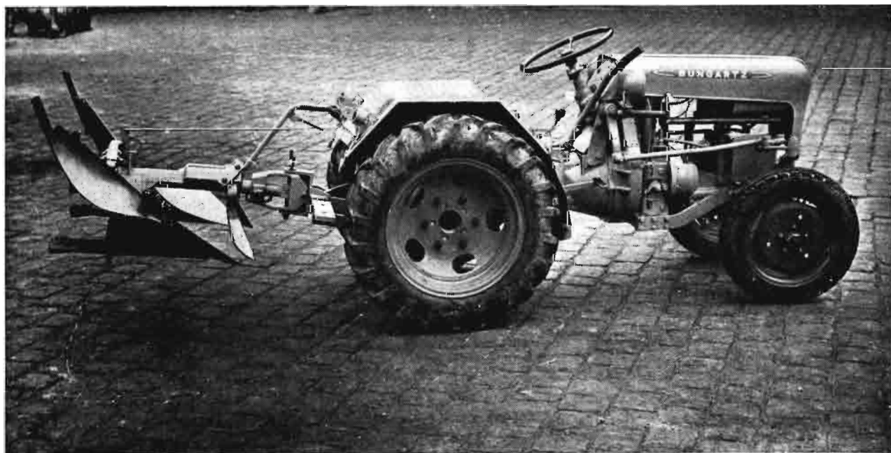
El sistema diesel ha conquistado toda la gama de potencias, como vemos en este modelo de tractor ligero de 12 C. V.
