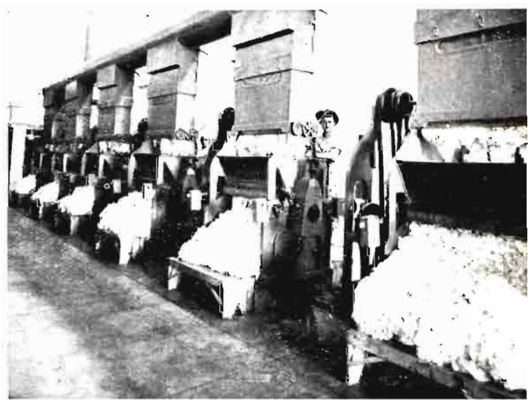
Maquinaria moderna de desmotación en la Factoría de Las Cabezas de San Juan (Sevilla) (1932).
