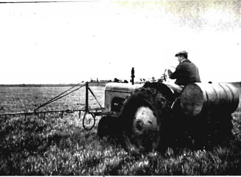
Tractor con máquina pulverizadora, especial para herbicida 2,4-D, dando un tratamiento a un cereal.
