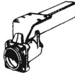
Con los ejes tubulares acodados se obtiene una mejor fijación de las ballestas junto al bastidor y por lo tanto mayor resistencia y estabilidad.
