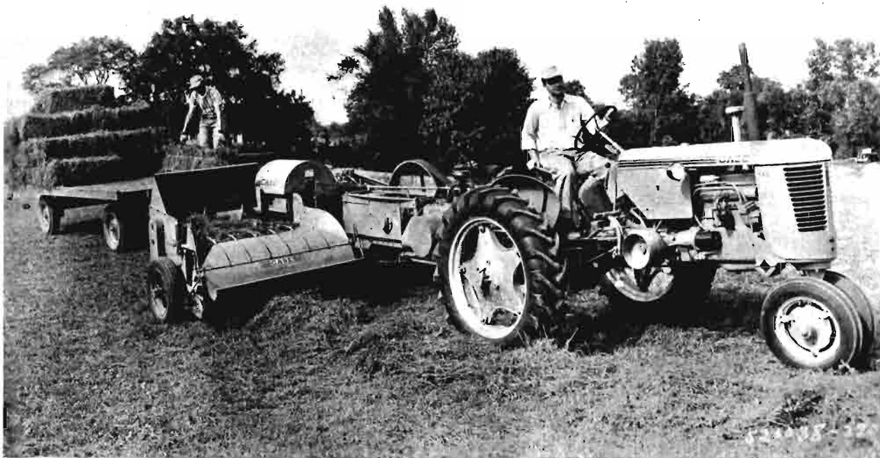
Las máquinas se hacen complicadas y revolucionan la técnica agrícola. Gracias a estas recogedoras empacadoras es posible ampliar el cultivo de forrajes y sostener más peso vivo de ganado en la finca.
