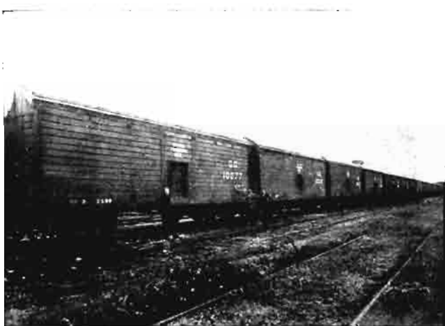
Tren de vagones cisternas con depósitos de acero esmaltado, de 40.000 litros de capacidad unitaria.
