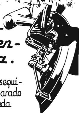
Los portadiscos son de un diseño original (solicitada patente) contruidos en acero forjado, girando los discos sobre amplios rodamientos de rodillos cónicos; tiene una amplia y completa graduación de 4 distintos ángulos de ataque en la tierra. Por este motivo, hacen que el arado pueda trabajar satisfactoriamente en toda clase de terrenos, lo mismo en las tierras fuertes o endurecidas, que en terrenos pedregosos o húmedos
