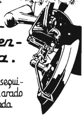
Los portadiscos son de un diseño original (solicitada patente) construidos en acero forjado, girando los discos sobre amplios rodamientos de rodillos cónicos; tiene una amplia y completa graduación de 4 distintos ángulos de ataque en la tierra. Por este motivo, hacen que el arado pueda trabajar satisfactoriamente en toda clase de terrenos, lo mismo en las tierras fuertes o endurecidas, que en terrenos pedregosos o húmedos.
