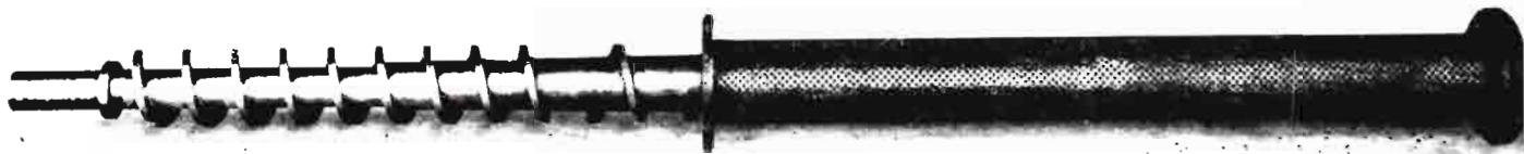
Vista del extractor y husillo del modelo industrial de la prensa sistema «Segura», experimentada, al parecer satisfactoriamente, en distintas almazaras durante la campaña a1951-52.
