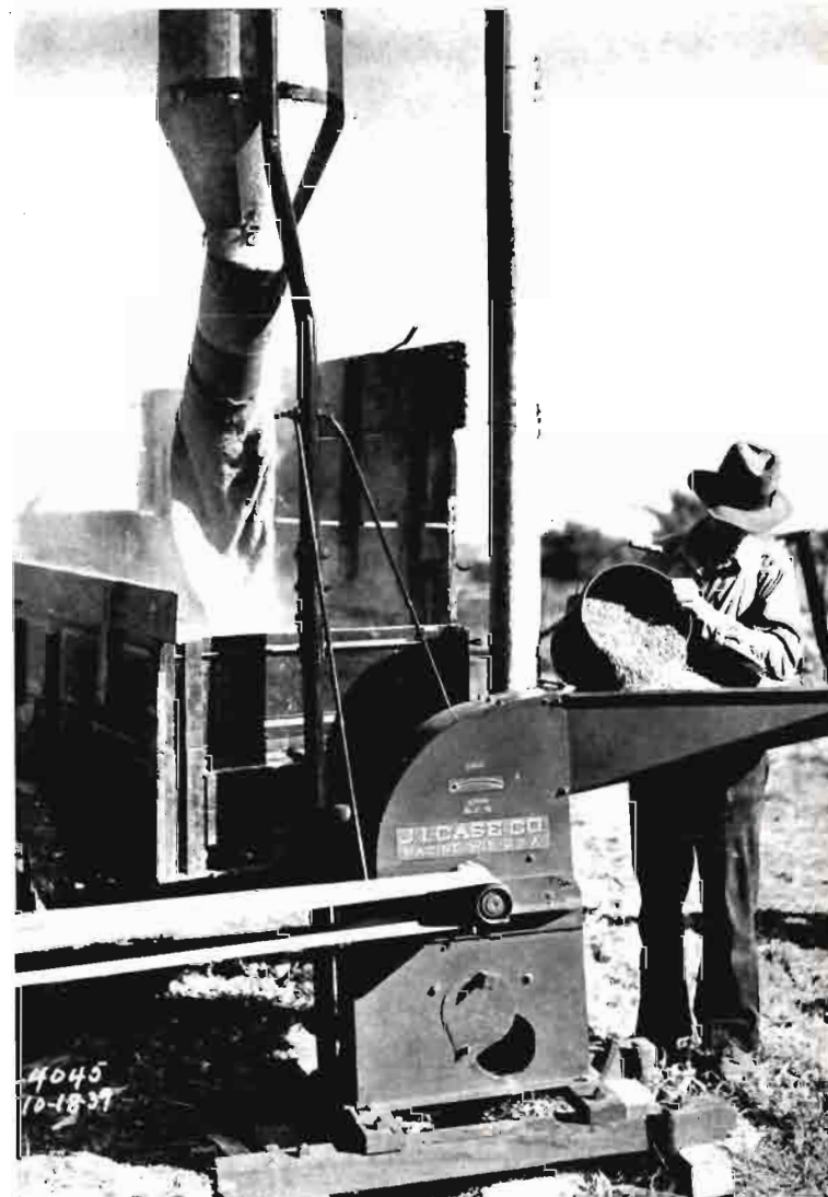
Esta es la potencia que interesa al agricultor: la que necesita en el eje del molino para moverle a su régimen; es decir, la potencia que se mediría con un freno puesto en lugar de la polea del molino y que por eso llamamos «potencia a la polea».
