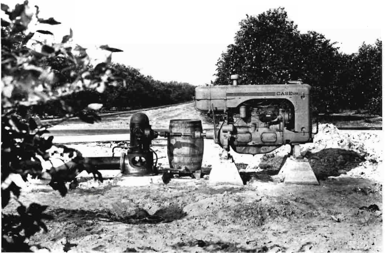
Si la potencia del motor se aplica directamente, las pérdidas mecánicas son mínimas, como en el accionamiento de esta bomba vertical. Frenado el motor, en el extremo del cigüeñal se obtendría la «potencia al freno».
