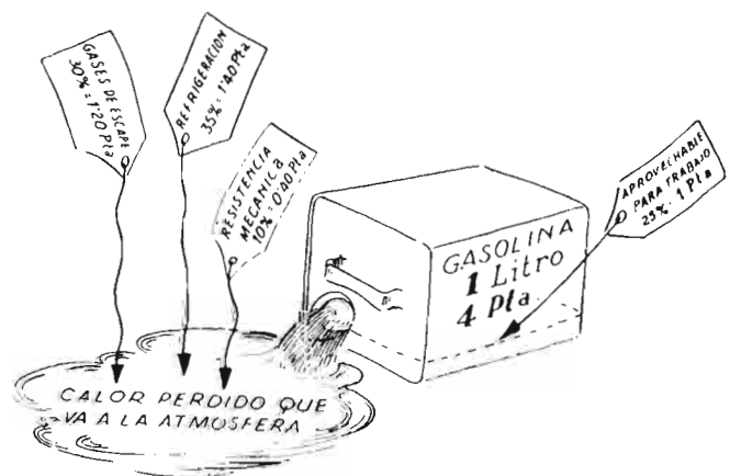
Del despilfarro que hacemos quemando la gasolina en el motor para obtener trabajo da clara idea este desconsolador balance térmico.
