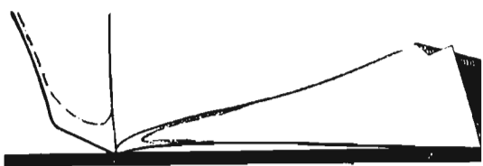
Figura 6 Reja vista lateralmente y por encima. Las líneas de puntos indican cómo se desgasta la punta de la reja, impidiendo su buena penetración.
