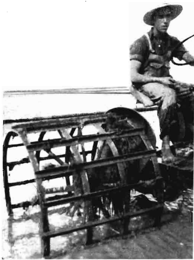
La idea de que el tractor sólo tiene aplicación en el gran cultivo se desvanece viéndole transformarse para ejecutar los trabajos más variados, como este «revoltre», en el arrozal, con ruedas de jaula.
