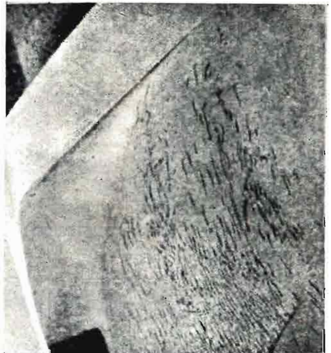
Los neumáticos hinchados a presiones excesivas o expuestos al sol presentan grietas pequeñas superficiales, que no son peligrosas si no se hacen mayores. La pintura corriente puede también causarlas. Ajustar la presión y proteger las ruedas de los elementos atmosféricos. Bastará para ello incluso una buena capa de barro.
