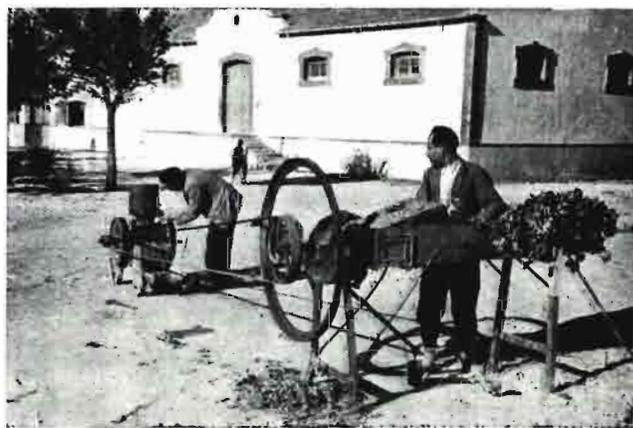
Corte de sarmientos con un cortaforrajes ordinario accionado por un motor de gasolina.
