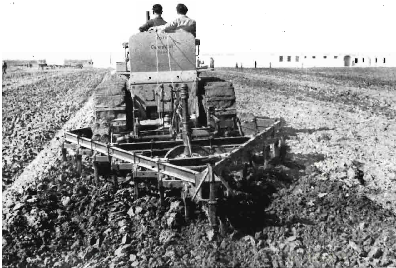
Arado Candau, construido en las factorías de Sevilla, trabajando con rejas escarificadoras. Al fondo, el Cortijo de Cuarto, de la Diputación Provincial de Sevilla, donde hoy radica la Escuela de Peritos Agrícolas.
