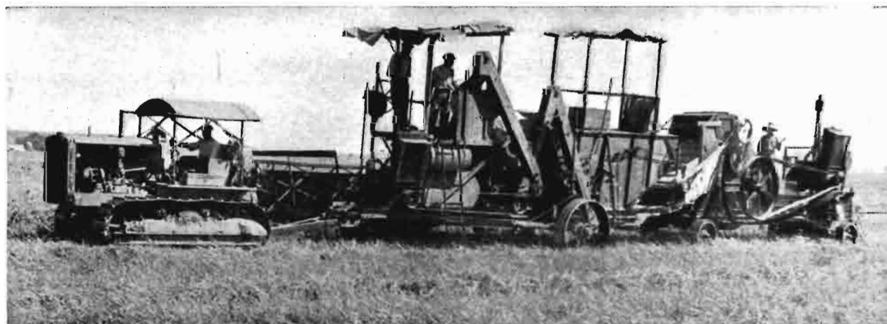
Tren compuesto de tractor cosechadora y elemento Candau. En él figuran un motor de 30 caballos, cilindro machacador y empacadora.
