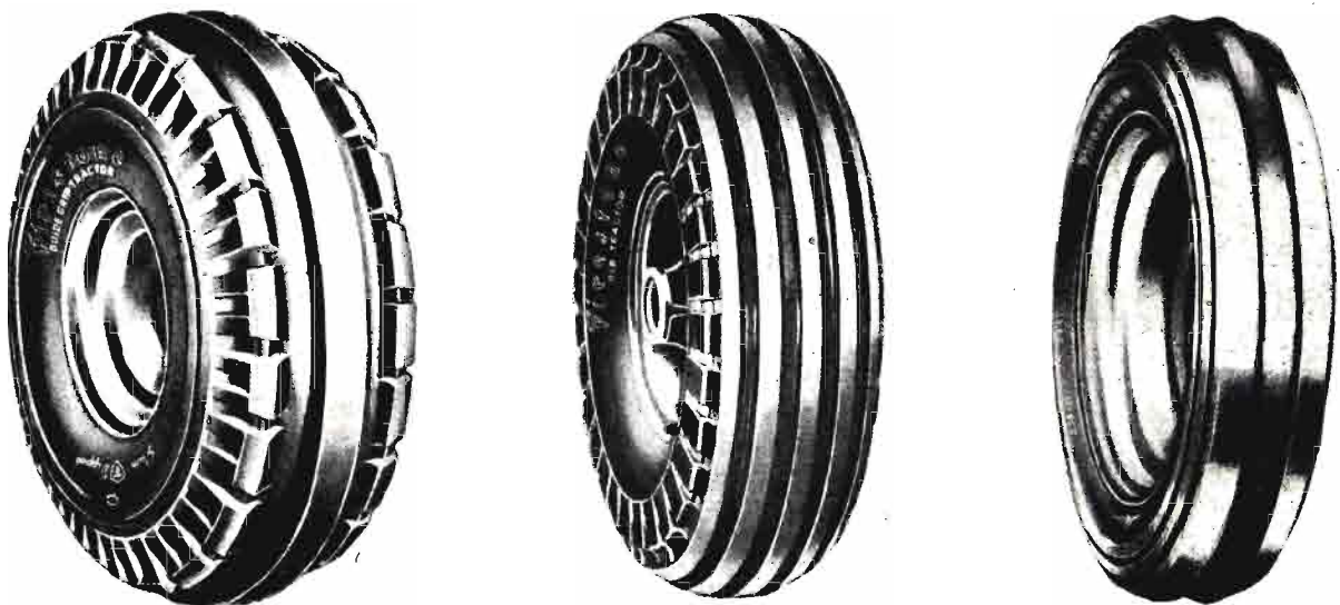
Las ruedas de transporte de las máquinas operadoras y las delanteras de tractor son de características análogas a las de automóvil, de presión media y secciones análogas; sólo las bandas de rodamiento se refuerzan, según su destino. A la izquierda, una cubierta para rueda delantera de tractor, con amplio y saliente nervio central, análogo al que llevaba su predecesora de hierro. La cubierta del centro es normal en toda clase de útiles agrícolas. La de la derecha es una curiosa cubierta para rueda trasera de arado, con banda de rodamiento en los hombros de la cubierta y costados reforzados, ya que en su marcha normal rueda inclinada de 15 a 30 grados con el plano vertical
