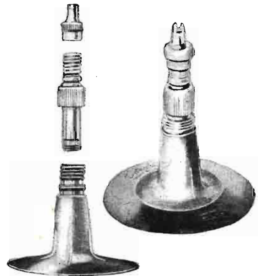
Las válvulas de las cámaras de tractor son hidroneumáticas, para permitir la carga de aire y agua indistintamente. El tapón preserva la válvula de escapes de aire y la protege del polvo; desenroscado, se inyecta el aire en el cuerpo de válvula, que constituye un portaobús postizo. La carga o descarga de agua se hace cómodamente quitando el portaobús y dejando sólo el soporte, que presenta un amplio orificio
