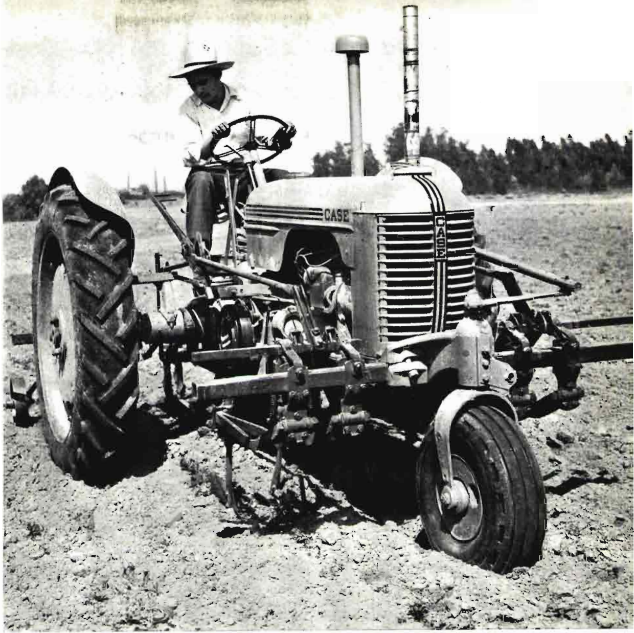
El tractor, montado como un triciclo, entra por el sembrado y labra las calles sin el más leve daño para las plantas de poca talla.
