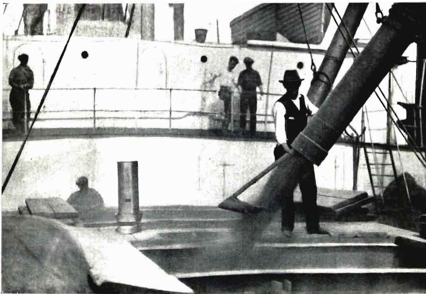
Fig. 3.—Tomando muestra con el «pelicano» en la bodega de un buque.
