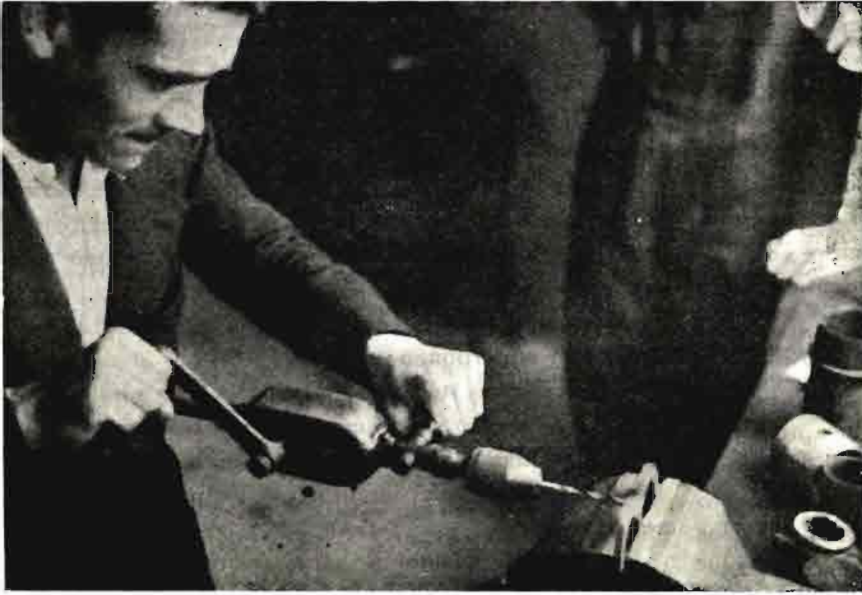
Un tractorista comprueba por sí mismo la resistencia del material taladrándolo. Es una forma sencilla de hacer su identificación y apreciar su calidad.
