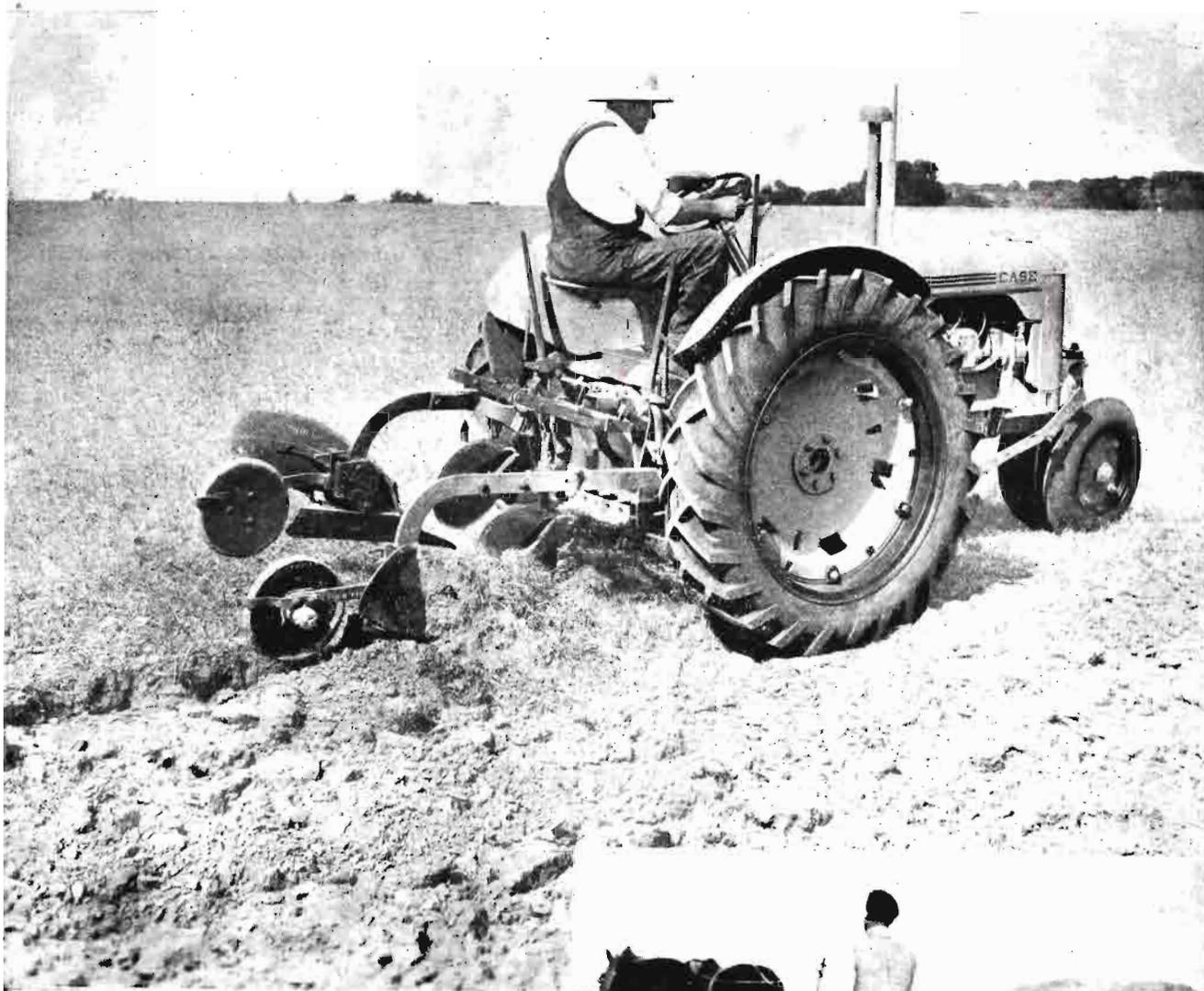
Los campos de arroz, tan perfectamente nivelados, sólo pueden labrarse con arados que dejen la tierra llana, como este monosarco basculante. Si, además, el arado se monta sobre el tractor, confiando al propio motor la maniobra de suspenderlo y descolgarle, es pequeñísimo el terreno desperdiciado para pasar de un surco al siguiente y cabe labrar parcelas de reducidas dimensiones. Estamos asistiendo al relevo, por el tractor, del arcaico brabant y la yunta.
